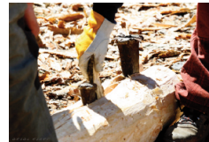
Posant el tasco de fusta de bedoll enmig de dos tascons de ferro
