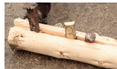
Tasco de fusta de bedoll enmig de dos tascons de ferro
